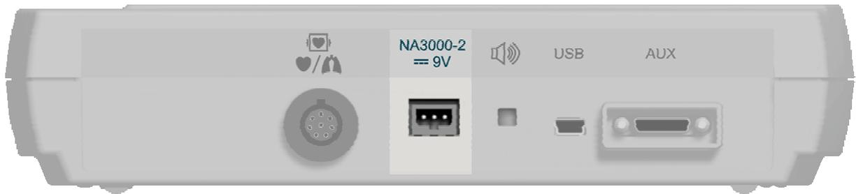
Abb. 13 Netzadapteranschluss
